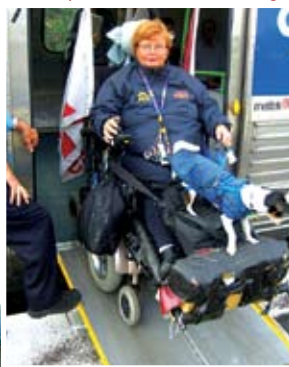
Risinājums dzelzceļa transportlīdzekļa pieejamībai, ar nodrošinātu izbīdāmu uzbrauktuvi Avots: http://search.creativecommons.org/
