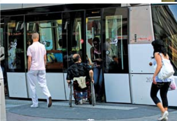
Risinājums dzelzceļa transportlīdzekļa pieejamībai, ar nodrošinātu izbīdāmu uzbrauktuvi Avots: http://search.creativecommons.org/
